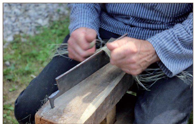
Fig. 16 – Utilisation du fer à espader pour l'assouplissement du chanvre présentée dans le cadre de la fête de l'artisanat à Grand'Combe-Châteleu dans le Jura en 2019 (photo M. Châtelet).
